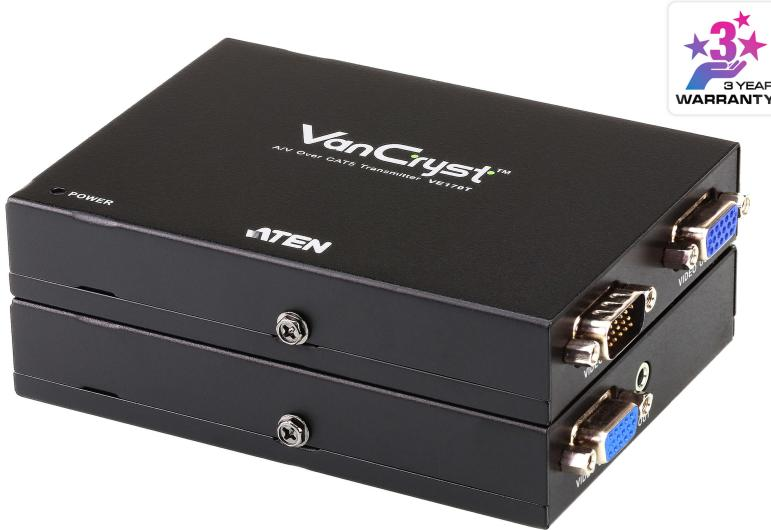
VE170はオーディオ・ビデオの信号を延長するエクステンダーです。製品はソースデバイスと接続するトランスミッター(VE170T)と、延長先でモニターやスピーカーが接続できるレシーバー(VE170R)から構成されており、これらのユニットをツイストペアケーブルで接続して最大300m先まで信号を延長することができます。本製品は単体でオーディオ・ビデオ信号を延長できるだけでなく、レシーバーVE170Rはビデオ分配送信器VS1204T/VS1208Tの受信器として使用することも可能です。
