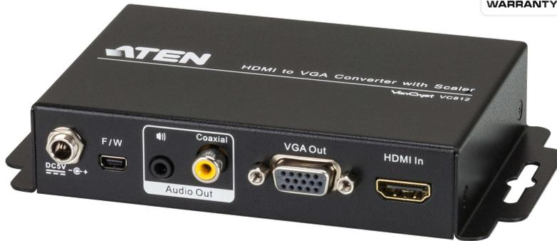
VC812は、HDMI信号をアナログVGA信号とオーディオ信号に変換するスケーラー搭載コンバーターです。本製品はビデオ解像度を最適な画質に変換するスケーラーエンジンを搭載。さらに、フロントパネルのボタンで操作するOSDを使用して、画質の調節や本製品の設定を簡単に行うことができます。
