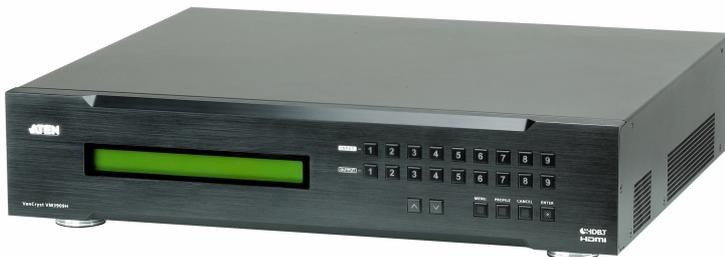
VM3909Hは、9系統のHDMI信号を9系統に延長・切替・分配できる、HDMIマトリックス送信器です。ミラーリング用ローカルポートを搭載しているので、ローカル側で、延長先のHDMI映像の出力状態を確認できます\*1。本製品はHDBaseT Class Bに準拠し、ソースデバイスからのHDMI信号をツイストペアケーブル1本で延長することができます。受信側に対応レシーバー\*2を使用することで、マルチメディアコンテンツを最大70m離れた場所に設置された複数のディスプレイにリアルタイムで分配・転送します。
