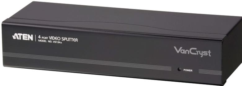
VS134Aは、1系統のVGAビデオ信号を4系統に出力する分配器です。3段階のカスケード接続に対応し、最大256系統にビデオ信号を分配することが可能です。本製品は、高品質のVGA、XGA、SVGA、UXGA、QXGA、マルチスキャンの各ビデオ信号を延長したいユーザーにとって最適なソリューションを提供します。
