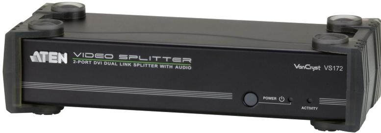
VS172は1系統のDVIデュアルリンクとオーディオの各信号を2系統に出力するビデオ分配器です。最大2,560×1,600の解像度に対応し、高品質な映像とサウンドを提供します。本体リア側にはRS-232Cポートを搭載し、シリアルコマンドで制御することができますので、お使いのシステムに統合して、本体に接続されたモニターやスピーカーを切り替えたりするのに活用することもできます。
