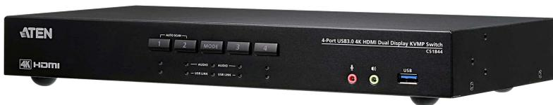
ATEN CS1844 Dual Display KVMP™スイッチは、1つのUSBキーボード、マウス、2つのHDMIモニターから4つのHDMIインターフェースコンピュータに瞬時かつ容易にアクセスできるデスクトップワークステーション向けの価値あるソリューションです。
