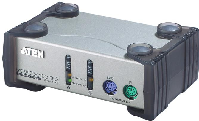
CS82Aは、1組のコンソールから2台のPS/2インターフェースコンピュータを接続し、切り替えて操作します。セットアップはケーブルを接続するだけでソフトウェアは不要。バスパワーで動作するので外部電源も必要ありません。コンピュータの切替は本体フロントパネルのプッシュボタンおよびホットキーで行います。PS/2キーボード・マウスエミュレーションにより、切替後のスムーズなコンピュータ操作が可能です。
