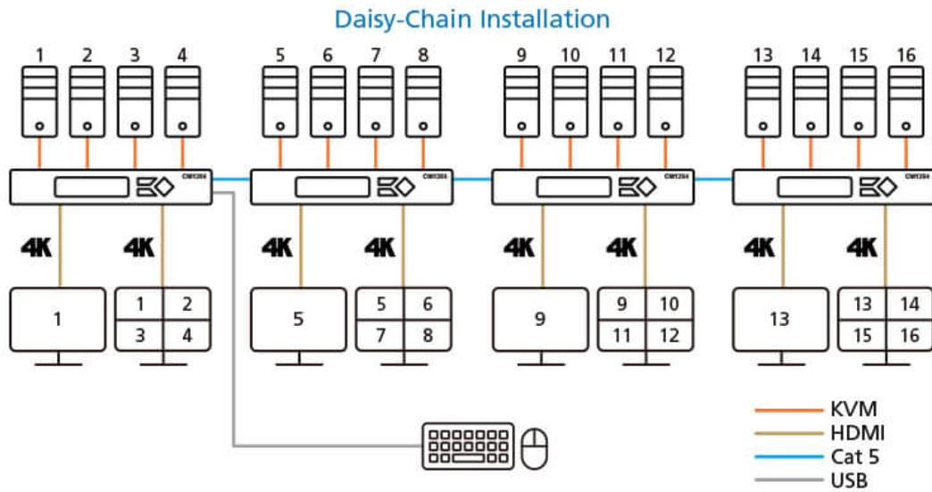
さらに、CM1284を4台（最大16のビデオソース）追加して1台のコンソールで接続し、最大4x4のマルチビューモードで映像を表示することにより、最大2段のカスケード接続も可能です。
