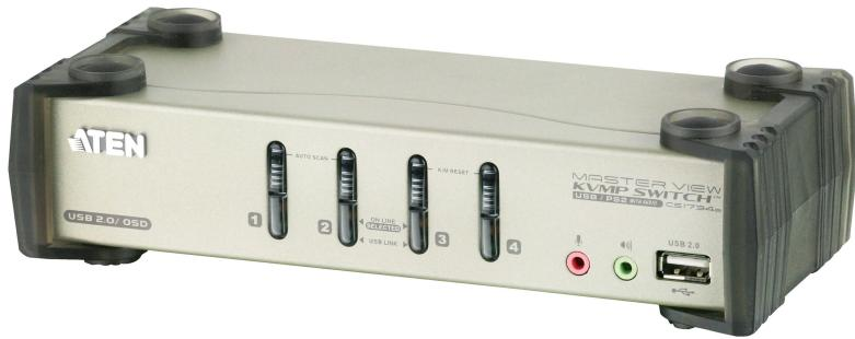
CS1734Bは、2ポートのUSB2.0ハブを搭載した4ポートのKVMスイッチです。1セットのコンソール(キーボード、マウス、モニター)から4台のコンピューターを操作可能です。プッシュボタン、ホットキー、日本語に対応したOSDからコンピューターを簡単に選択することができます。
