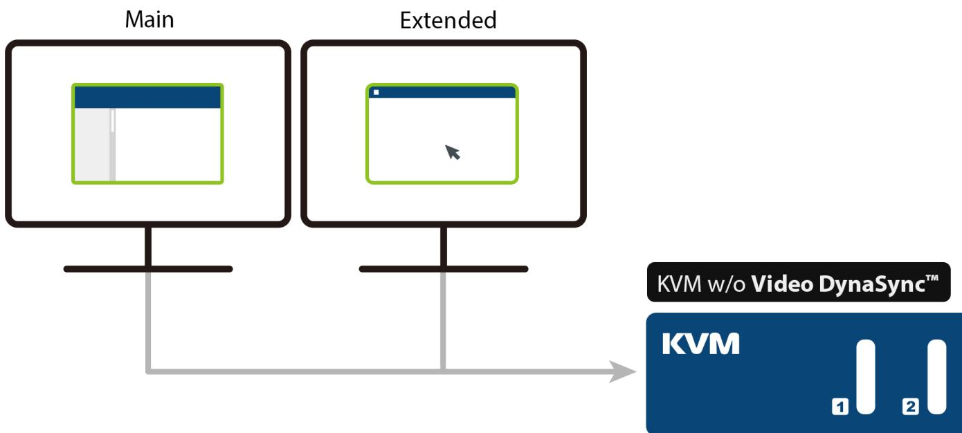
より多くのディスプレイを監視する必要がある場合、ユーザーは2台のCS1842をデジーチェーン接続して、最大4台のディスプレイでマルチタスクを容易に実行し、膨大な情報を処理することができます。さらに、リモートポートセレクターにより、プッシュボタン、ホットキー、マウスポートの切り替えとは別に、迅速かつ合理的なポート選択が可能です。
