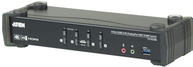
CS1924Mは、最新のMST（マルチストリームトランスポート）テクノロジーを採用しており、MSTハブを内蔵した世界初のDisplayPort KVMスイッチです。1つのDisplayPort 1.2ビデオソースから2つのコンソールディスプレイに接続可能で、かさばるケーブル接続を行う必要がありません。また、最大4K解像度で拡張デスクトップモードとスプリッタモードが使用可能です。
