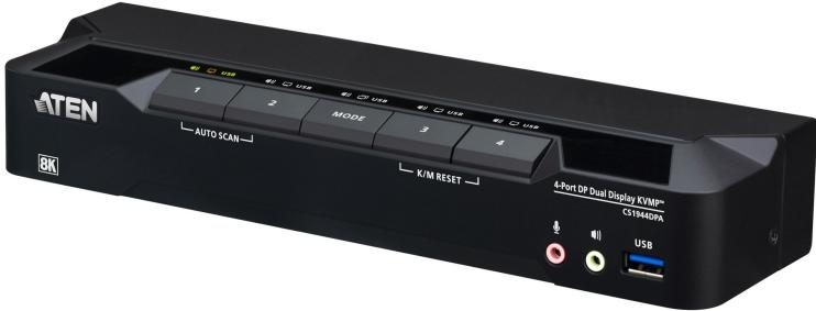
CS1944DPAは、DisplayPort 1.4に準拠し、8K解像度のデュアルディスプレイに対応した4ポートUSB DisplayPort KVMP™スイッチです。1組のUSBキーボードとマウスで複数のDisplayPortコンピューターを切り替えて操作でき、限られた作業スペースでも効率的なデスクトップ環境を構築できます。DCC（デイジーチェーン制御）により、2台のユニットを接続することでクアッドディスプレイ（4画面構成）へ拡張可能です。高精細でクリアな映像を複数のディスプレイに出力できるため、デザイン、映像編集、CAD/CAM、金融・証券取引、行政業務など、高解像度と作業効率が求められる用途に最適です。
