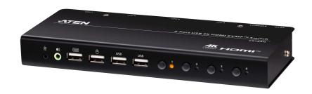
CS784Hは、複数のシステム間を効率的に切り替えながら、高品質な映像表示を求めるユーザーのために設計された、4ポートデスクトップ<u>KVMスイッチ</u>です。最大4台のHDMI対応PCを4K DCI解像度で高速かつ安定して切り替え可能で、キーボード・モニター・マウス・音声出力・USB周辺機器を1つのKVMコンソールで共有できます。切り替えは本体のブッシュボタン、キーボードのホットキー、リモートボートセレクターなど複数の方式に対応。オフィス業務や<u>コンテンツ制作</u>、リモートワーク、デザイン業務など、幅広いデスクトップ環境で理想的なソリューションとなる製品です。
