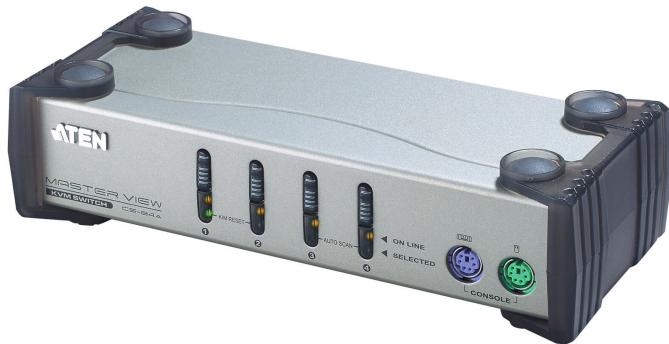
CS84Aは、1組のコンソールから4台のPS/2インターフェースコンピューターを接続し、切り替えて操作します。セットアップはケーブルを接続するだけでソフトウェアは不要。バスパワーで動作するので外部電源も必要ありません。コンピューターの切替は本体フロントパネルのプッシュボタンおよびホットキーで行います。PS/2キーボード・マウスエミュレーションにより、切替後のスムーズなコンピューター操作が可能です。
