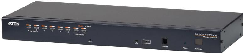
KH1508Aiは、ネットワーク経由でサーバーへのアクセス・操作ができる8ポートKVMスイッチです。本製品は単体で最大8台、また、デイジーチェーン接続による15台の増設で最大128台のサーバーをそれぞれ接続することができ、これらのサーバーに対して、ローカル/リモートで1バスを共有して遠隔地から操作します。サーバーとの接続には、インターフェースやOSに応じて種類を選ぶことができる「コンピューターモジュール」とカテゴリ5/6eケーブルを使用するため、OSやインターフェースが混在するサーバー環境でも簡単にコンソールを集約します。
