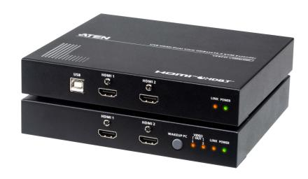
CE824は、HDBaseT 2.0技術により、HDMI映像、USBキーボード/マウス、オーディオ、RS-232制御信号を、1本のCat 6ケーブルで最大100m以上延長できる<u>KVMエクステンダー</u>です。HDMI デュアルディスプレイに対応しているため、リモートユニット(CE824R)から2画面で効率的に操作が行えます。コントロールセンター、医療施設、倉庫など、長距離にわたる信号延長 と<u>KVM</u>制御を必要とする環境に理想的なソリューションです。
