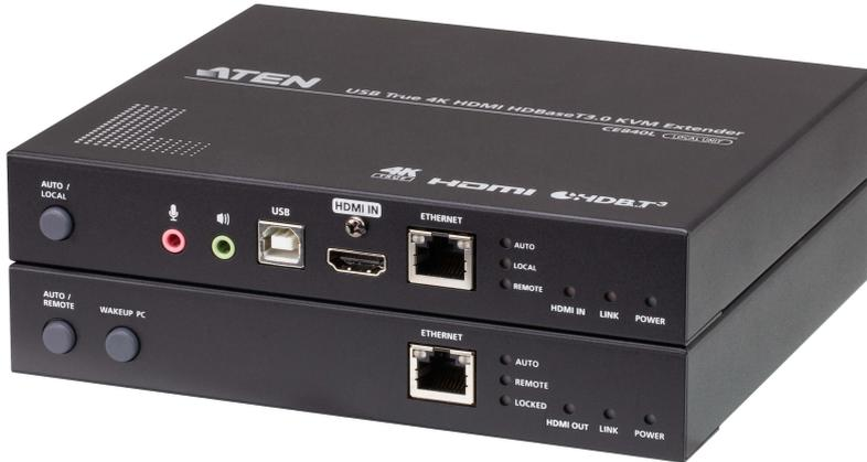
CE840 USB HDMI HDBaseT 3.0 KVM エクステンダーは最新のHDBaseT 3.0技術により、1本のHDBaseT製品向けCat6Aケーブル\*で、非圧縮True 4K HDMIビデオ、ステレオオーディオ、USB、イーサネット、RS-232Cの各信号を最大100m延長します。
