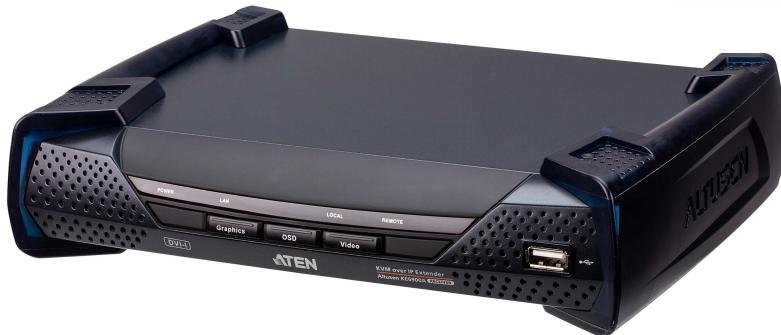
DVI対応IP-KVMエクステンダー「KE69シリーズ」は、イーサネット経由でPCのコンソール（USBキーボード/マウス・DVIモニター）を延長設置することができます。
