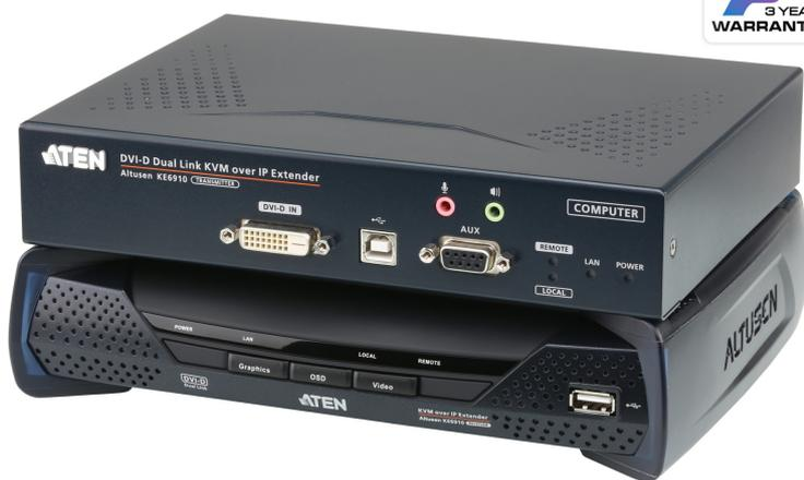
KE6910は、2K解像度に対応したデュアルリンクDVI-D IP-KVMエクステンダーです。この製品は、IPベースのトランスミッター（KE6910T）と、レシーバー（KE6910R）から構成されています。KE6910は、リモートUSBコンソール（USBキーボード、USBマウス、DVIモニター）からイントラネットを介してPCへのアクセスを実現する製品のため、ユーザーはPCをワークステーションから離して、安全で空調管理された環境にセットアップすることができます。
