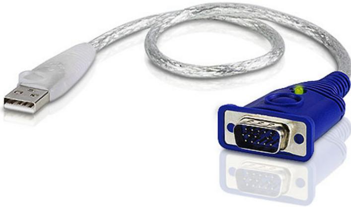
2A-130Gは、コンピューター/ビデオ ソース側でローカルディスプレイを使用しない場合に、KVMエクステンダーやビデオエクステンダーに接続して使用するVGA EDIDエミュレーターです。不揮発性メモリーにあるデフォルトのATEN EDID設定をエミュレート・保存するため、コンピューター/ビデオ ソースが直接接続されていなくてもディスプレイを認識させることができます。ディスプレイを使用しない環境でも本製品を使用することによってブート時のエラーを回避することができるため、シンプルで低コスト、かつ利便性の高いソリューションとして最適です。
