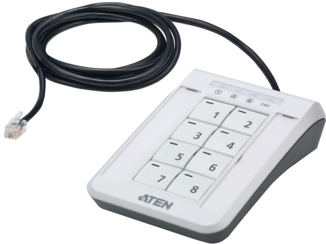
2XRT-0022Gは、ATEN PP v4.0 セキュアKVMスイッチに接続された複数のコンピューターを切り替えるために設計された有線リモコンです。リモコンのボタン操作で、コンピューターを簡単に選択できます。プラグアンドプレイで複数のPCを瞬時に切り替えられるだけでなく、改ざん防止ラベルや常時稼働型シャーシ侵入検知機能など、セキュアKVMスイッチに不可欠な機能を提供することで、利便性と安全性を両立します。
