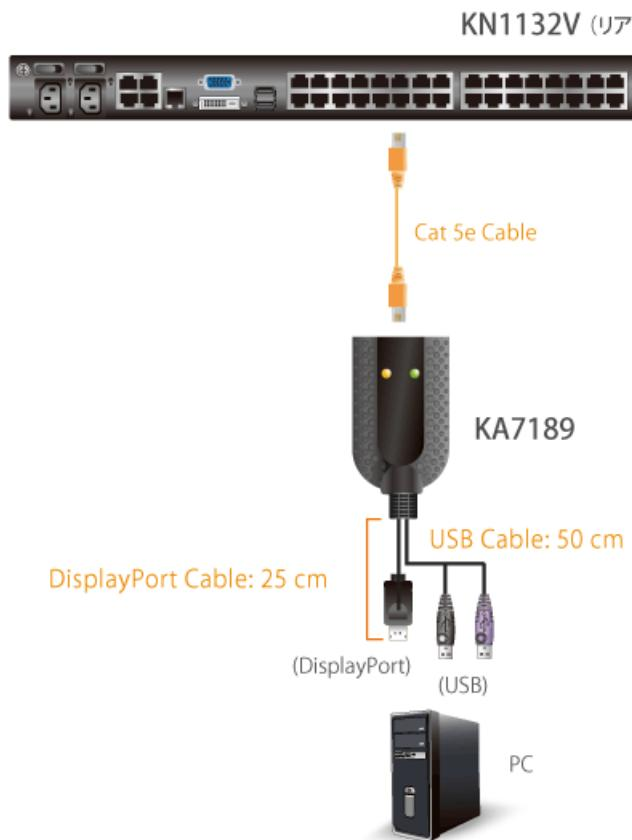
電源供給のため、2個のUSBコネクター両方をUSBポートに挿入してください。
