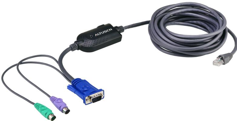
KA7920は、カテゴリ5タイプのALTUSEN KVMスイッチとPS/2インターフェースのコンピューターとの接続に使用するコンピューターモジュールです。4.5mのカテゴリ5ケーブルが一体型になった本製品は、コンパクトな本体と軽量なデザインを特長とし、優れた信号補正の技術を提供しますので、ラックマウント型、タワー型のどちらのタイプのサーバーでもお使いいただけます。
