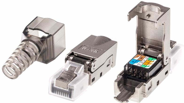
ATEN 2A-245G [Cat 6A](#) RJ-45コネクタは、優れた電磁干渉（EMI）保護を提供し、10G以上のデータ転送をサポートします。再装着可能な金属シールドとダイキャスト設計により、750回以上のRJ-45ジャック挿抜でも安定した伝送と耐久性を確保します。PoE/POHに対応し、特に[2L-29330 Cat 6A ケーブル](#)と互換性があります。工具を使わずにすばやく取り付けることができ、22から26 AWGまでのケーブルをサポートします。RoHS/REACH規格に準拠し、IP20防塵カバーが付属しています。
