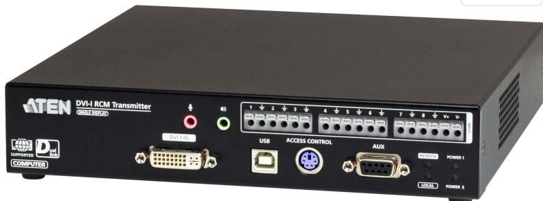
RCMDVI50Tは、DVIインターフェースのコンピューターのコンソールをネットワーク経由で最大10km延長できる高性能なIP-KVMトランスミッターです。
