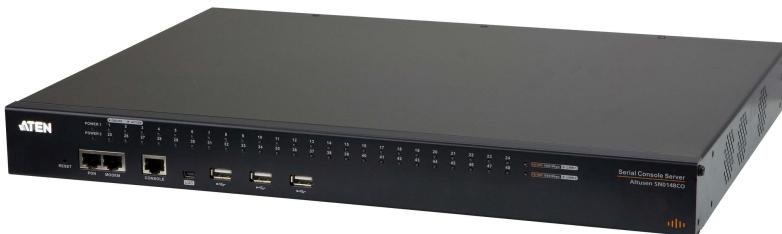
ATENシリアルコンソールサーバー SN01xxCO シリーズ（[SN0108CO](#) / [SN0116CO](#) / [SN0132CO](#) / SN0148CO）は、遠隔地に設置されたシリアルデバイス（ネットワークスイッチなど）に対して、IPネットワークを使用しないセキュアなリモートアクセスやアウトオブバンド・アクセスの手段を提供できる製品です。本シリーズの導入によって、分散した小規模システムから中～大規模なサーバールームやデータセンターに至るまで、管理者は場所や時間を問わずシリアル制御機器の管理が行えるため、移動時間やMTTRコストを最小限に抑え、IT生産性を最大限に引き出すことができます。
