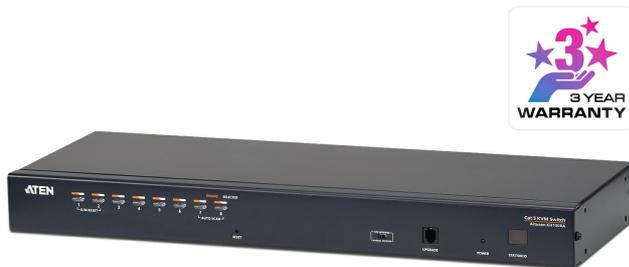
KH1508Aは、1箇所のPS/2またはUSBコンソール（キーボード、モニター、マウス）から単体で8台のサーバーにアクセスし、制御できるカテゴリ5eタイプの8ポートKVMスイッチです。本製品を最大31台までダイジーチェーン接続することで、最大256台のサーバーが1箇所のコンソールから操作できます。
