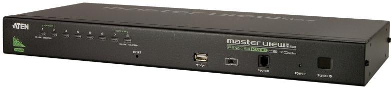
CS1708Aは、8台のコンピューターの切替機能を搭載したKVMスイッチです。本製品は単体での使用に加え、最大31台のKVMスイッチを追加してデイジーチェーン接続することもできます。これによって、1箇所のコンソールから最大256台のコンピューターを操作することが可能ですが。更に、フロントパネルのUSBポートにUSBデバイスを接続すると、製品に直接接続されているすべてのコンピューターからそのUSBデバイスを切り替えてアクセスすることができます。
