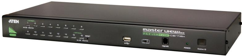
CS1716Aは、16台のコンピューターの切替機能を搭載したKVMスイッチです。本製品は単体での使用に加え、最大31台のKVMスイッチを追加してデイジーチェーン接続することもできます。これによって、1箇所のコンソールから最大512台のコンピューターを操作することが可能です。更に、フロントパネルのUSBポートにUSBデバイスを接続すると、製品に直接接続されているすべてのコンピューターからそのUSBデバイスを切り替えてアクセスすることができます。
