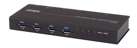
US3344Iは、キーボード・マウス・PC周辺機器などのUSB3.2 Gen1デバイス4台をコンピューター4台で切替ながら共有することができる4ポート USB3.2 Gen1デバイス共有器です。どのコンピューターでUSBデバイスを使用するかは、リモコン、もしくはシリアルコマンドを使用して選択するこ とができます。
