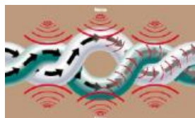
図3. ギャップ発生時の外部ノイズ影響
