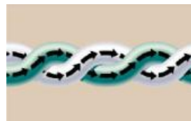
図2. Bonded-Pairによる、シグナルの正常化 (インピーダンスミスマッチの解消)
