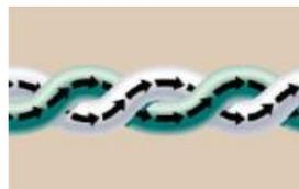
図2. Bonded-Pairによる、シグナルの正常化
