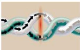
図1. ギャップ発生時のリターン・ロス現象
