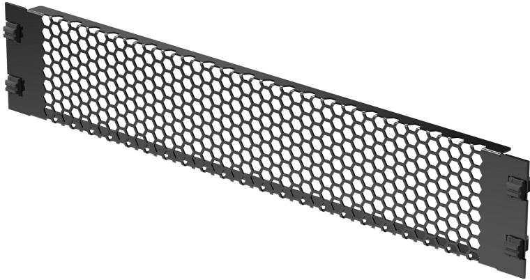
ラック内の空きUを塞ぐ際、完全に閉じてしまうとエアフローが阻害され、機器の温度上昇につながるケースがあります。ATENの通気型ラックパネルは、誤って手をしてしまうことで起きる事故や、異物混入対策と放熱性を両立するためのラック用アクセサリーです。
