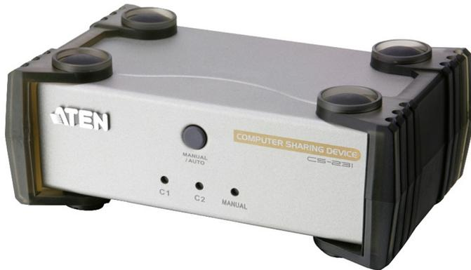
CS231은 강력한 마이크로 프로세서 컨트롤 기반의 컴퓨터 공유 디바이스입니다. CS231은 멀티 유저, 싱글 태스킹 장치로써 2명의 사용자가 각자의 콘솔(모니터, 키보드, 마우스)로 하나의 컴퓨터를 공유하여 사용 할 수 있습니다. CS231은 USB 콘솔이며, PS/2와 USB 컴퓨터를 모두 지원합니다.
