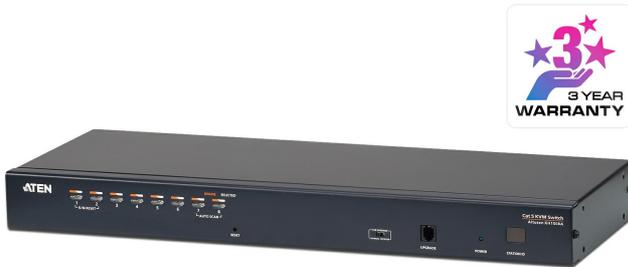
KH1508A KVM 스위치는 IT 관리자들이 하나의 PS/2 혹은 USB KVM 콘솔(키보드, 모니터, 마우스)을 통해 여러 대의 컴퓨터를 액세스 하고 제어하도록 하는 컨트롤 유닛입니다. 사용자는 최대 8대의 컴퓨터를 제어할 수 있습니다. 데이지 체인 연결을 통해 최대 31대의 스위치를 연결하여 최대 256대의 컴퓨터를 기존 KVM 콘솔에서 제어할 수 있습니다.
