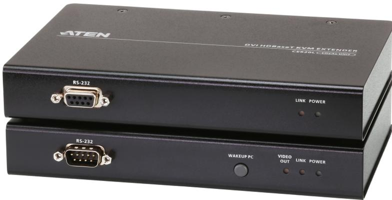
CE620은 HDBaseT™ 2.0 기술을 통합하여 안정적인 비디오, 오디오, USB, RS-232 신호 전송을 제공합니다. 롱 리치 모드를 지원으로 하나의 Cat6/6a/ATEN [2L-2910](#) Cat 6 케이블을 사용하여 고품질 DVI 비디오, PCM 2채널 디지털 오디오, USB 2.0, RS-232 신호를 최대 150m까지 전송합니다. 다양한 신호를 지원하는 간편한 케이블 설치로 교통 제어 센터, 의료 시설, 산업용 창고, 확장형 워크스테이션과 같이 편리한 원격 접속이 필요한 환경에 적합합니다.
