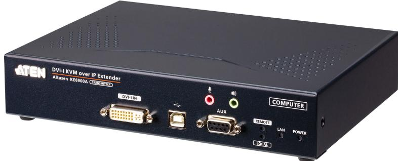
KE6900A 연장기는 고성능 IP 기반 송신기(KE6900AT)로 구성된 컴퓨터와 수신기(KE6900AR)로 구성되어 별도의 위치에서 콘솔에 접근할 수 있게 합니다. KE6900A는 인트라넷을 통해 USB 콘솔(USB 키보드, USB 마우스, DVI 모니터)을 통해 원격으로 컴퓨터 시스템에 대한 접근을 허용하여 사용자가 컴퓨터 시스템을 안전한 온도 제어 환경에 들 수 있게 하며 사용자 작업대와 분리 시킬 수도 있습니다.
