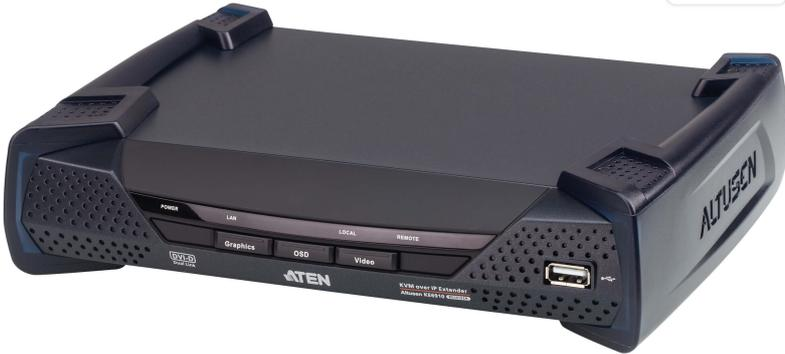
KE6910은 컴퓨터에 연결되는 고성능 IP 기반 송신기(KE6910T)와 별도의 위치에서 콘솔 접속을 제공하는 수신기(KE6910R)로 구성됩니다. KE6910은 인트라넷을 통해 원격 USB 콘솔(USB 키보드, USB 마우스, DVI 모니터)에서 컴퓨터 시스템에 접속할 수 있도록 하여 사용자 워크스테이션과 격리된 안전하고 온도가 제어되는 환경에서 컴퓨터를 이용할 수 있도록 합니다.
