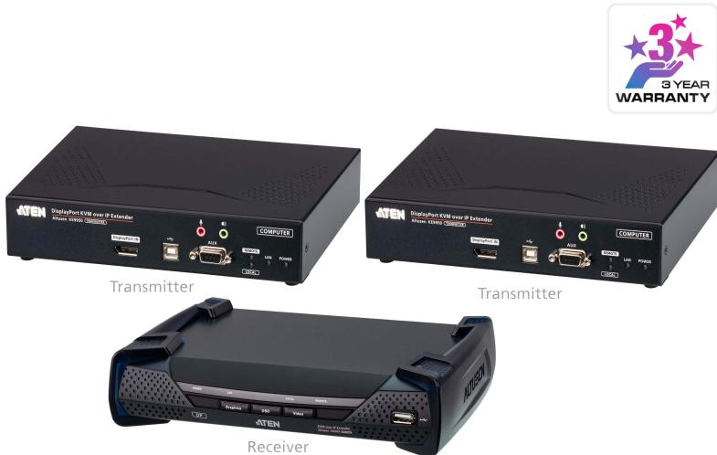
**KE9950** 번들 솔루션(Air Traffic Control Bundle Solution, 항공 교통 관제 번들 솔루션) - KE9950ATC는 2대의 PC/서버에 연결되는 2개의 고성능 IP 기반 송신기([KE9950T](#))와 별도의 위치에서 콘솔 접속을 제공하는 IP 기반 수신기([KE9950R](#))로 구성됩니다. 솔루션은 통해 거리 제한이 없는 손쉬운 IP 확장을 구축하여 미션 크리티컬 데이터센터의 비상 상황에 더 빠르게 대응할 수 있습니다. 프라이머리-세컨더리 아키텍처를 사용하는 솔루션은 워크스테이션을 이동하지 않고 핫키 전환을 통해 시스템 패일오버를 가능하게 하는 프라이머리-세컨더리 컴퓨터에 연결할 수 있도록 합니다. 솔루션을 구축하면 인트라넷을 통해 원격 USB 콘솔(USB 키보드, 마우스 및 DisplayPort모니터)에서 컴퓨터 시스템에 접속할 수 있으므로 컴퓨터를 사용자 워크스테이션과 격리된 안전하고 온도가 제어되는 환경에 배치할 수 있습니다.
