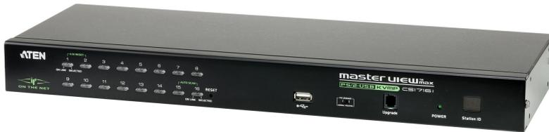
CS1716i KVM 스위치는 로컬/리모트 양 쪽에서 수많은 컴퓨터를 모니터링하고 액세스 할 수 있는 IP 기반의 KVM 컨트롤 유닛입니다. 리모트 유저는 TCP/IP 통신 프로토콜을 이용한 인터넷을 통해 스위치에 액세스 합니다. CS1716i는 싱글 버스 컴퓨터 액세스를 위한 최대 32명의 동시 유저 로그인을 지원합니다. 인터넷 채팅 프로그램(메시지 보드)과 같은 기능이 내장되어 있어 상호간 정보 교환이 실시간으로 가능해 효과적이고 매끄러운 관리가 가능합니다.
