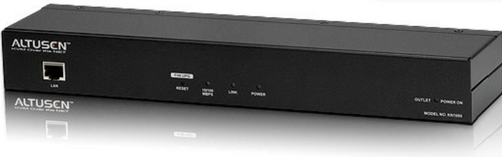
KN1000은 서버에 원격 BIOS 레벨접속이나 over-IP 기능이 내장되어 있지 않은 KVM 스위치에 “over-IP” 기능을 제공하는 제어 장치입니다. 멀리 떨어진 곳에서 작업자가 표준 인터넷브라우저 혹은 윈도우/자바 기반 프로그램을 사용하여 컴퓨터를 모니터링하고 액세스 하도록 하여, 직접적인 인력이 필요없이 사이트 상에서 BIOS 레벨까지 문제 해결이 가능하도록 합니다. 또한 KN1000은 외부 모뎀 지원을 포함한 아웃 오브 밴드 액세스 제공합니다.
