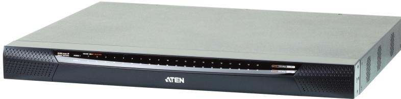
ATEN의 4세대 KVM over IP 스위치는 우리의 기대를 훨씬 뛰어넘었습니다. [KN2140VA](#)는 최대 1920 x 1200 HD 해상도의 우수한 비디오 품질 및 레벨 1 보안 표준 FIPS 140-2를 지원하며 두 배 빠른 버추얼 미디어 전송이 가능합니다.
