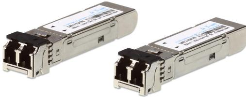
2A-136G 멀티 모드 1.25G 광 SFP 트랜시버 모듈은 최대 550m 까지 1GbE 연결을 제공합니다. 2A-136G는 송신기 및 수신기 양단에 설치됩니다. 광 통신을 위한 표준 듀플렉스 커넥터를 갖춘 핫 플러그 모듈인 2A-136G는 멀티 모드 광 (MMF) 연결로 동작하고 850nm의 공칭 파장에서 동작하는 경제적이고 효율적인 고성능 SFP 모듈입니다.
