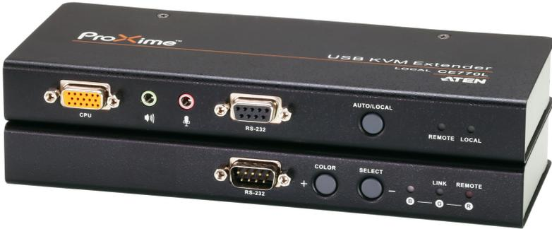
CE770 제품은 Deskew 기능을 지원하는 USB 기반의 KVM 연장기(Extender)입니다. 자동적으로 신호를 보정하는 기능과 RS-232 시리얼 기능을 지원함으로써 원격 USB 콘솔로부터 컴퓨터 시스템에 액세스할 수 있습니다. 또한 CE770 제품은 RGB 신호를 수동으로 동기화시킬 수 있는 RGB 지연 동기 기능을 지원합니다. 이 기능을 통해 사용자는 시스템 장비를 먼 거리에 설치할 수 있으며, CE770 제품의 라인 동기화 기능을 통해 색상 변화 및 타이밍 에러를 보정할 수 있습니다. 또한, 사용자가 수동으로 R/G/B 신호 설정의 조절이 가능합니다.
