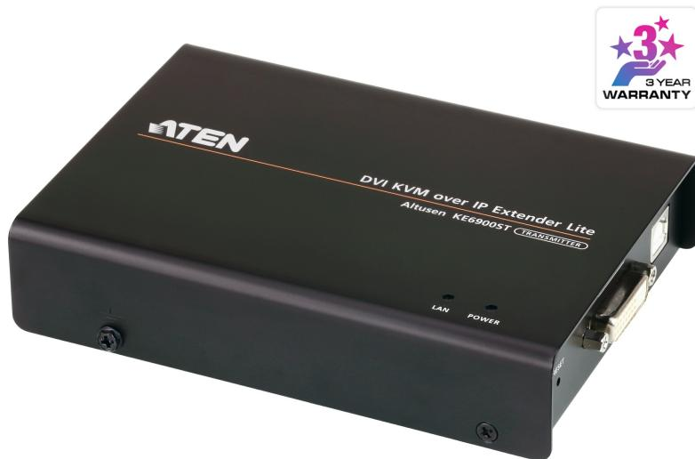
KE6900ST는 고성능 IP 기반 송신기로 인트라넷을 통해 원격 USB 콘솔(USB 키보드, USB 마우스, DVI-D 모니터)에서 컴퓨터 시스템에 접속할 수 있도록 지원합니다. 이를 통해 사용자는 컴퓨터를 작업 환경과 분리된 안전하고 온도 조절이 가능한 환경에서 사용할 수 있습니다. 모든 연장기는 KE 시리즈\* 수신기 또는 송신기와 함께 사용할 수 있어 예산 규모에 알맞은 경제적인 솔루션을 구축 할 수 있습니다.
