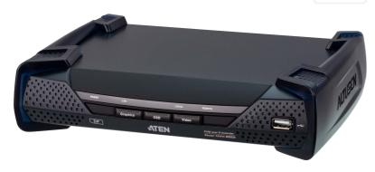
KE9950 4K DisplayPort 싱글 디스플레이 KVM over IP 연장기는 고성능 IP 기반 송신기 KE9950T로 구성되어 컴퓨터를 수신기에 KE9950R에 연결하여 분리된 장소에서 콘솔 접속이 가능하도록 합 니다. <u>KE9950</u>은 리모트 USB 콘솔 (USB 키보드, USB 마우스, DisplayPort 모니터)에서 인트라넷을 이용하여 컴퓨터 시스템에 접속할 수 있도록 하여, 사용자의 워크 스테이션에서 분리된 안전하고 온도 조절된 환경에 컴퓨터 시스템을 설치할 수 있도록 합니다.
