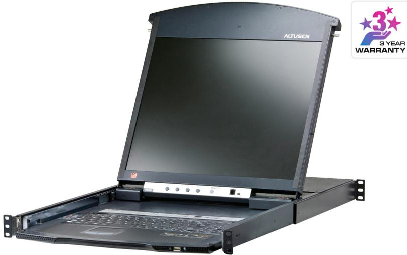
KL1516Ai 듀얼 레일 LCD KVM 스위치는 하나의 KVM(키보드, 비디오 및 마우스) 콘솔에서 최대 16대의 컴퓨터에 안전하게 접속할 수 있는 제어 장치입니다. 1U 랙 장착형 접이식 슬라이딩 하우징에 LCD 모니터, 키보드 및 터치패드가 통합되어 있습니다.
