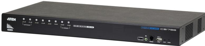
CS1798는 단일 USB 키보드, USB 마우스, 모니터 즉 콘솔에서 최대 8대의 HDMI 컴퓨터에 대한 접속 및 제어를 통합할 수 있는 스위치입니다. CS1798을 3단계 캐스케이드 방식으로 연결하여 하나의 콘솔에서 최대 512대의 컴퓨터를 제어할 수 있습니다.
