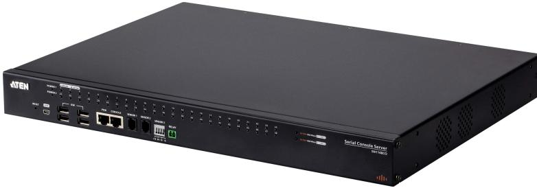
SN11xxCO 시리즈(SN1116CO/SN1132CO/SN1148CO)는 데이터 센터 또는 원격 사이트에 있는 시리얼 장치(RS-232 및 USB 콘솔을 사용하여 콘솔 작동을 허용하는 네트워크 스위치 등<sup>1</sup>)에 대한 안전한 대역 외 액세스를 제공합니다. 이중 전원/SFP<sup>2</sup> 텁재로 최첨단 기술이 통합되어 편리한 설치, 안전한 시리얼 장치 액세스, 쉬운 관리, 데이터 센터에 대한 포괄적인 제어를 제공합니다. 추가적인 대역 외 네트워크 접속을 위해 USB 4G 동글<sup>3</sup>도 지원합니다.
